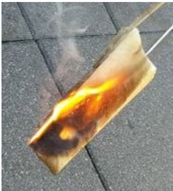
Afbeelding 6: Isolatiemateriaal uit naastgelegen melklokaal kort blootgesteld aan een open vlam.
