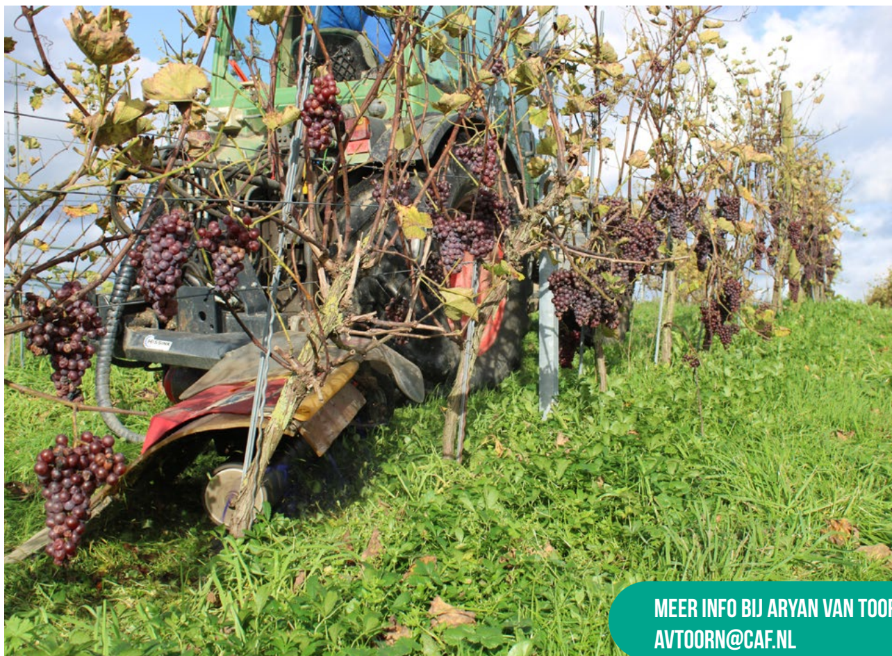
Draadjesmaaier slaat onkruid uit de bomenrij.
