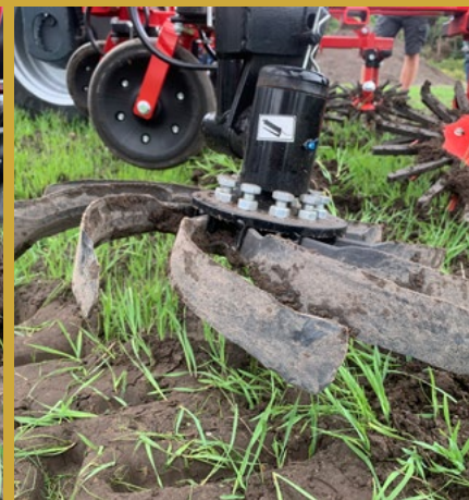
De Busa is een voorbeeld van een roterende schoffel waarmee je rond 10 km/uur kunt rijden.
