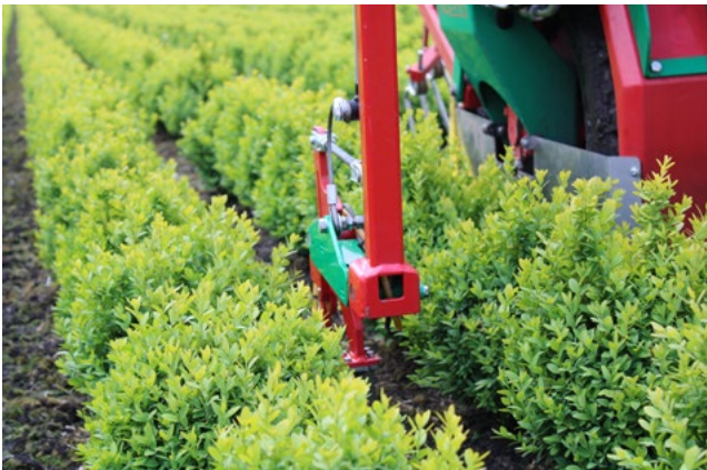
Met LVS (Laag Volume Strooien) tussen en onder het gewas is veel middel te besparen.
