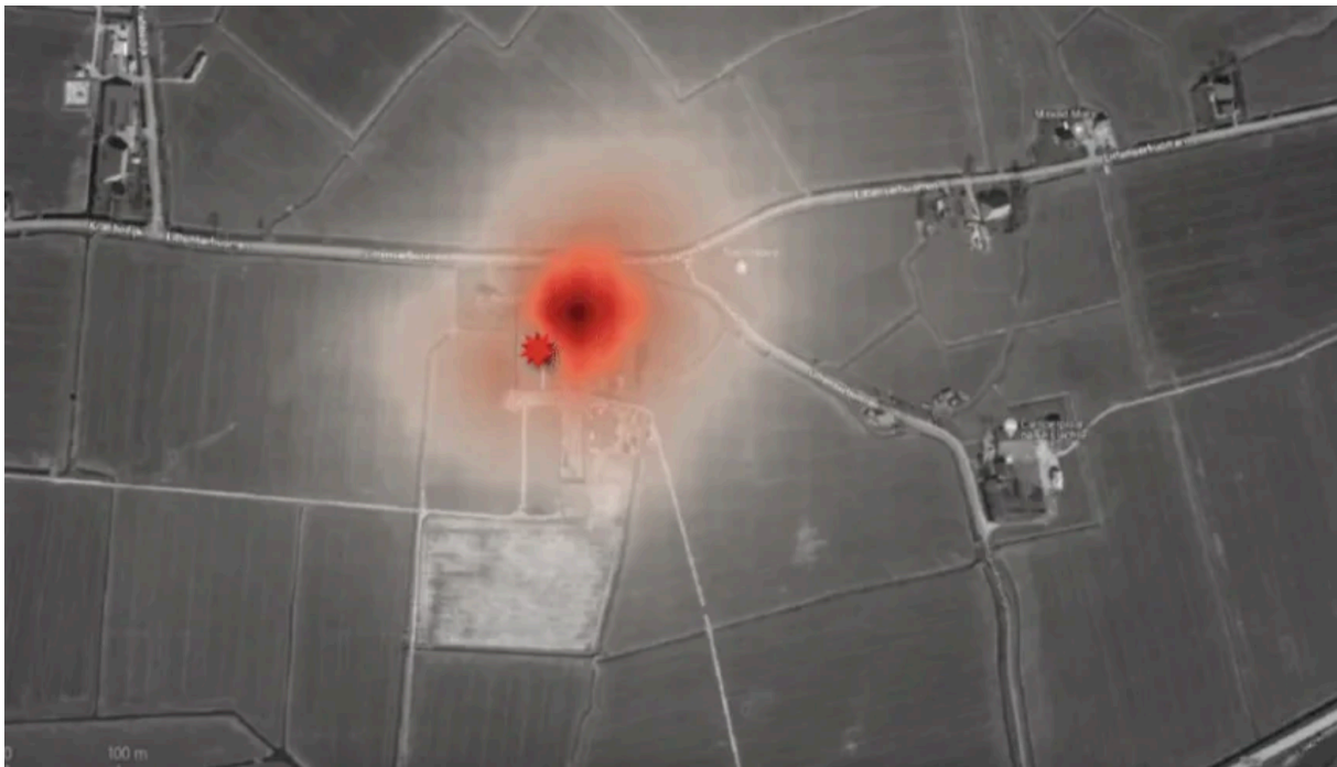
Figuur 4.14: Een eerste OPS-berekening waarin de depositie in rood is weergegeven. Hoogste waarde is 600 mol per hectare per jaar (8,5 kg), in de simulatie heeft de stal 120 koeien extra wat overeenkomt met een emissie van 1440 kg. In tegenstelling tot eerdere figuren is de depositie-kleur lineair en niet logaritmisch. (Bron: Richard Zijlstra)
