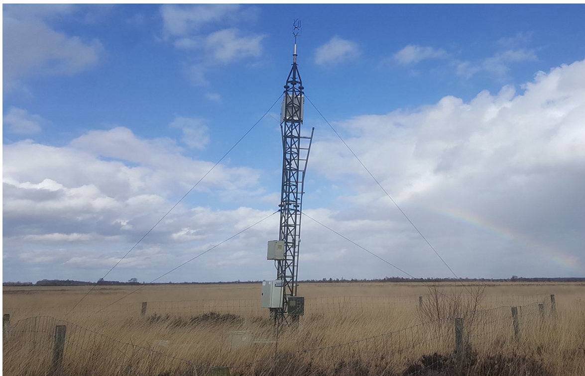
COTAG-Paal, methode waarmee op basis van de ammoniakconcentratie op twee verschillende hoog de flux (droge depositie) in het verticale vlak experimenteel wordt bepaald. Directe droge depositie metingen bestaan niet. In Nederland staan al langer drie COTAG palen, recent zijn er enkele palen bijgeplaatst.
