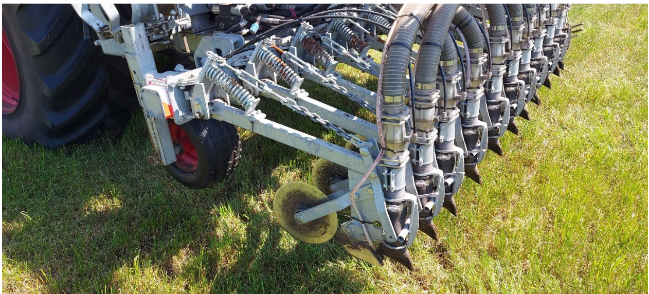
Figuur 1. Mesttank met sleufinjecteur voor proefvelden.
