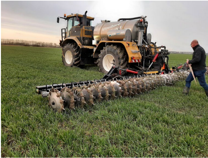
Figuur 4. De ammoniumsulfaat is in de wintertarwe toegediend met de spaakwielbemester.
