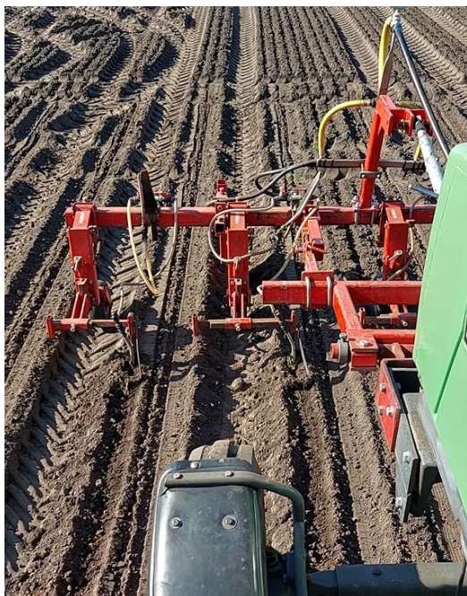
Figuur 2. Injectiesysteem om de urine naast de rij in de mais te plaatsen
