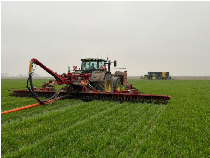
Figuur 3. De varkensdrijfmest en de urine is in de wintertarwe toegediend met een zodebemester met sleepslangen-aanvoersysteem.
