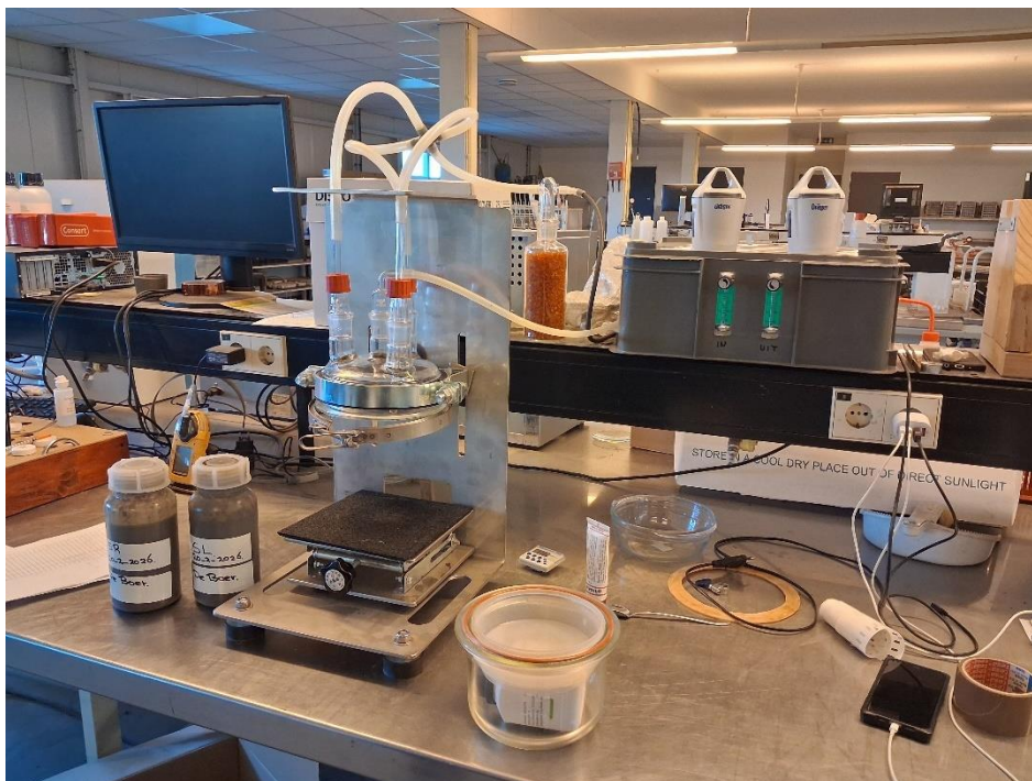
Foto 2.2 Proefopstelling bij ALNN (Ferwert) voor meting van de potentiële ammoniakemissie volgens methode Topmest (Vanhoof).
